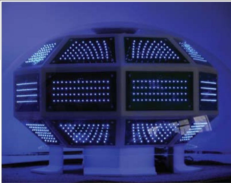
Ce prototype d'un émetteur-récepteur, mesurant 60 cm de diamètre, fait partie intégrante du sous-marin télérobotique inventé par Greg Baiden.
